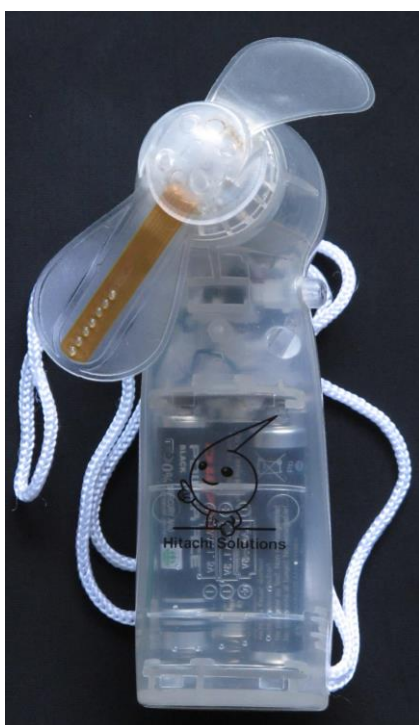
Fig. 4 扇風機の柔らかな羽根に配置されたLEDアレイ
