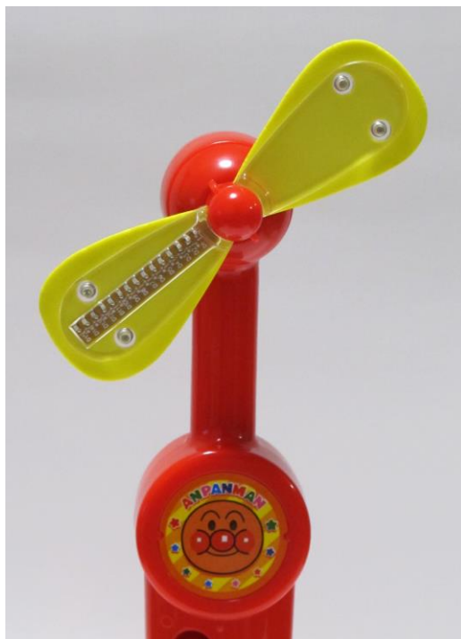
Fig. 2 回転する羽根に配置されたLEDアレイ
